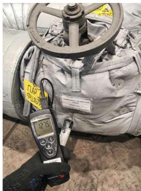
Рисунок А 7 – Замеры температура на задвижке «Пар до фильтра №1» (ТГ-4). Температура на поверхности термочехла – 27,5°C (слева), температура на границе термочехол/арматура – 127,5°C (справа)
