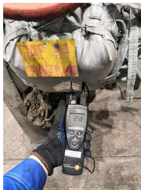
Рисунок А 4 – Замеры температура на задвижке «Пар на фильтр №1» (ТГ-2). Температура на поверхности термочехла – 41,4°С (слева), температура на границе термочехол/арматура - 258°С (справа)
