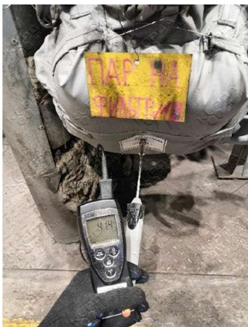
Рисунок А 4 – Замеры температура на задвижке «Пар на фильтр №1» (ТГ-2). Температура на поверхности термочехла – 41,4°С (слева), температура на границе термочехол/арматура - 258°С (справа)
