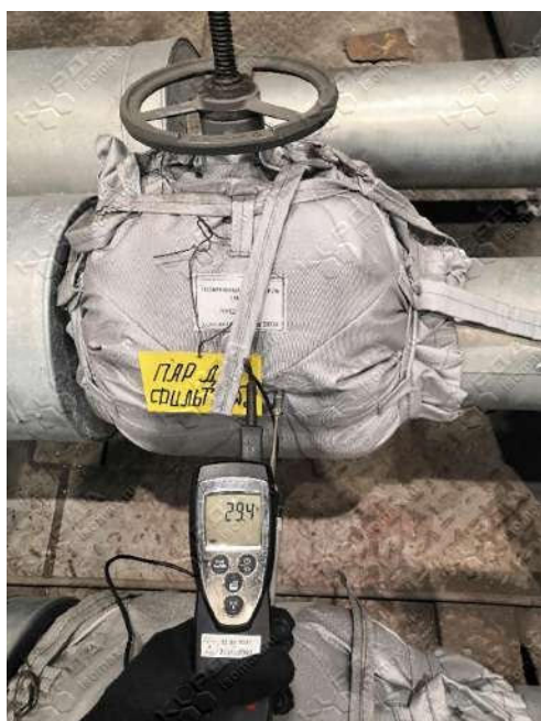
Рисунок А 8 – Замеры температура на задвижке «Пар до фильтра №2» (ТГ-4). Температура на поверхности термочехла – 29,4°C (слева), температура на границе термочехол/арматура – 154,1°C (справа)
