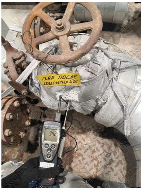
Рисунок А 10 – Замеры температура на задвижке «Пар после фильтра №2» (ТГ-4). Температура на поверхности термочехла – 34,2°C (слева), температура на границе термочехол/арматура – 135,9°C (справа)
