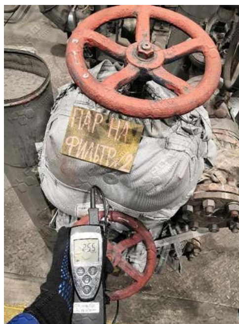
Рисунок А 5 – Замеры температура на задвижке «Пар на фильтр №2» (ТГ-2). Температура на поверхности термочехла – 47,4 (слева), температура на границе термочехол/арматура - 255°C (справа)
