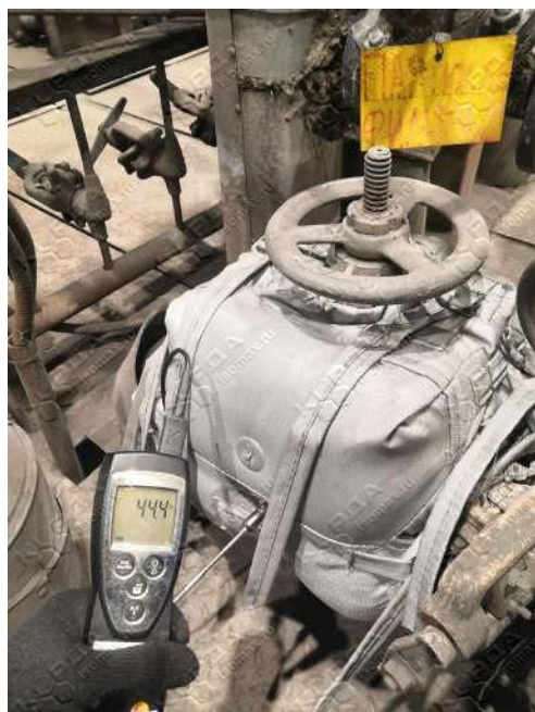
Рисунок А 6 – Замеры температура на задвижке «Пар после фильтра №2» (ТГ-2). Температура на поверхности термочехла – 44,4 (слева), температура на границе термочехол/арматура – 208°C (справа)
