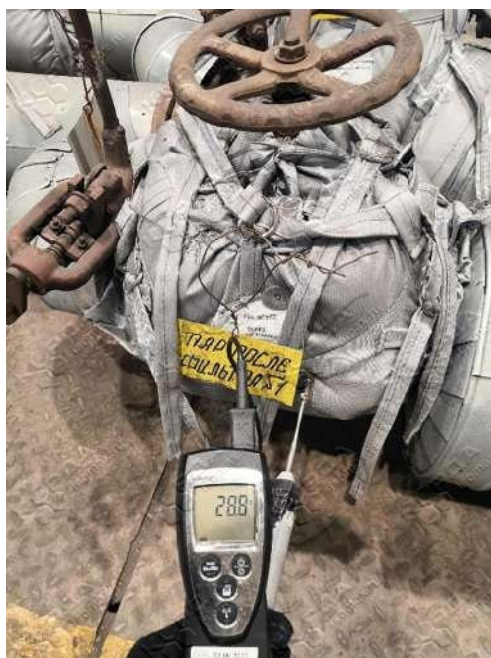
Рисунок А 9 – Замеры температура на задвижке «Пар после фильтра №1» (ТГ-4). Температура на поверхности термочехла – 28,8°C (слева), температура на границе термочехол/арматура – 137,9°C (справа)
