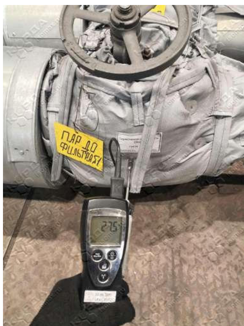
Рисунок А 7 – Замеры температура на задвижке «Пар до фильтра №1» (ТГ-4). Температура на поверхности термочехла – 27,5°C (слева), температура на границе термочехол/арматура – 127,5°C (справа)
