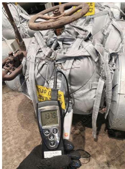
Рисунок А 9 – Замеры температура на задвижке «Пар после фильтра №1» (ТГ-4). Температура на поверхности термочехла – 28,8°C (слева), температура на границе термочехол/арматура – 137,9°C (справа)
