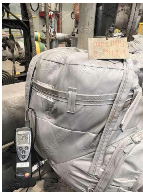
Рисунок А 3 – Замеры температура на задвижке «Пар с РПУ в ПНД-1» (ТГ-2). Температура на поверхности термочехла – 42,9°С (слева), температура на границе термочехол/арматура - 273°С (справа)
