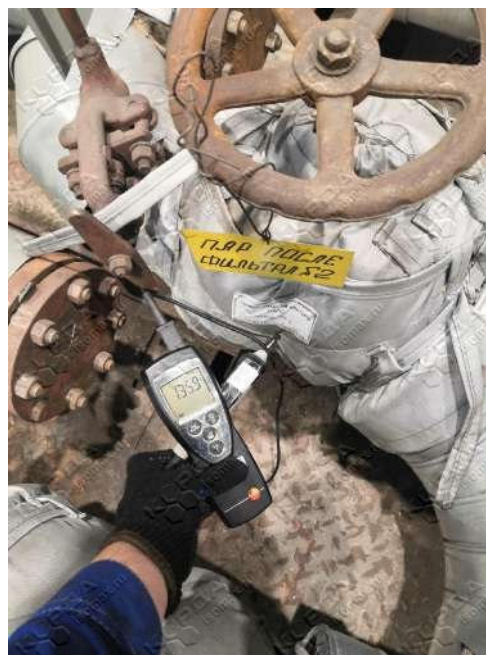
Рисунок А 10 – Замеры температура на задвижке «Пар после фильтра №2» (ТГ-4). Температура на поверхности термочехла – 34,2°C (слева), температура на границе термочехол/арматура – 135,9°C (справа)
