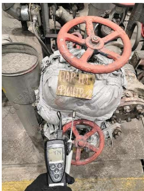
Рисунок А 5 – Замеры температура на задвижке «Пар на фильтр №2» (ТГ-2). Температура на поверхности термочехла – 47,4 (слева), температура на границе термочехол/арматура - 255°C (справа)
