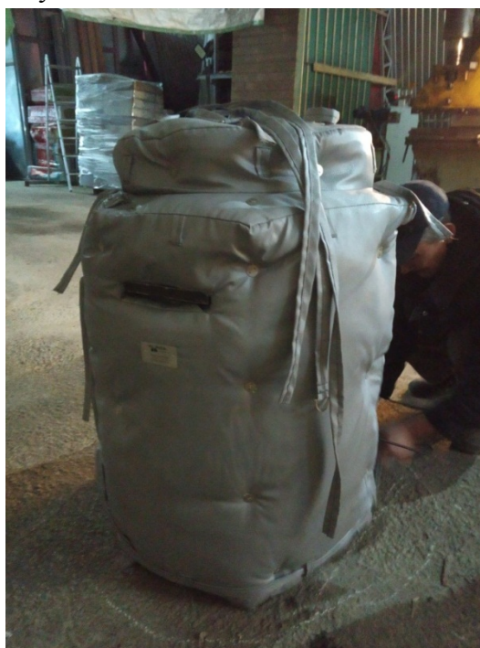
Рисунок 12. Общий вид чехла на источнике шума
